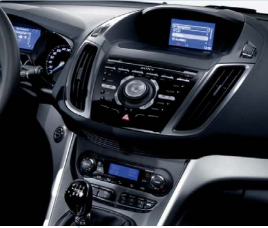
Fertig eingebaut: Blende der Bedienung, mit der man Telefon, Musik und Navigation im neuen Ford C-Max nutzt.
